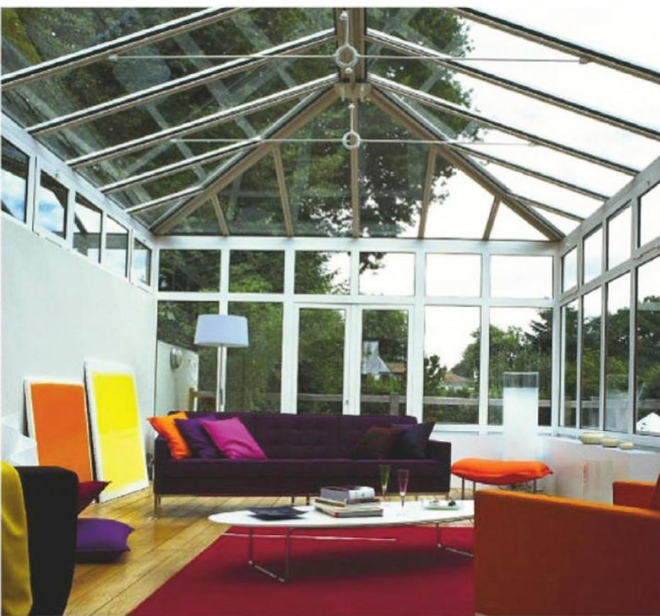
**PANORAMIQUE** Tout en verre : on profite d'une vue à 365° sur le jardin alentour. Isolation assurée grâce à des chevrons à rupture de pont thermique. L. 7 m x l. 4,5 m. En aluminium. "Tourmaline", Technal, prix sur devis.
