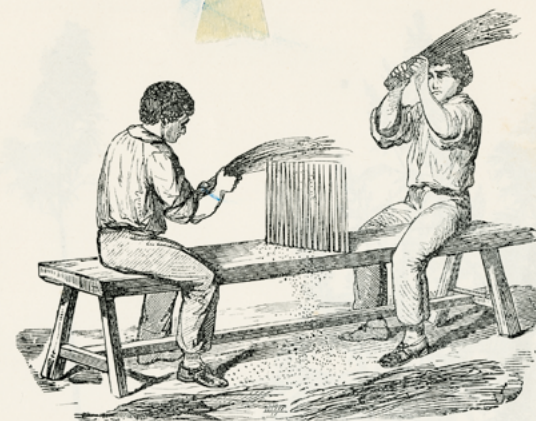
Fig. 1814. — Operai che sgranellano il lino.
